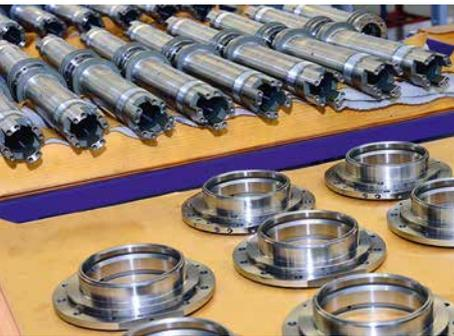
**Das Fertigungs-Spektrum bei kptec components umfasst Spindelwellen für Dreh-, Fräsbearbeitungs- und Schleifmaschinen, Motorspindeln sowie alle möglichen hochgenauen Teile mit hohem Schleifanteil für den Werkzeugmaschinen-sektor, für Prüfstände und den Betriebsmittelbau.**
