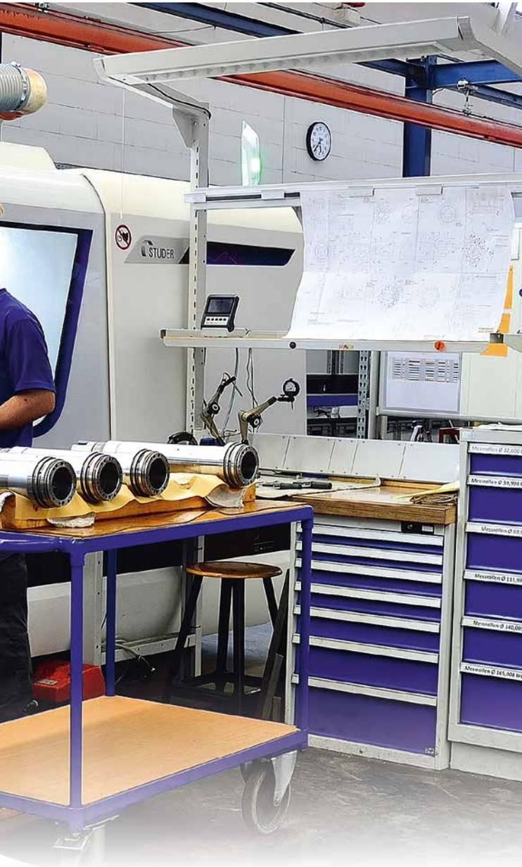
Die S41 von Studer ist eine CNC-Universal-Rundschleifmaschine der neuesten Generation. Sie verfügt über viele technische Feinheiten wie zum Beispiel das revolutionäre StuderGuide Führungsbahnsystem, die hochpräzisen Achsantriebe mit Linearmotoren und den extrem schnellen Direktantrieb der B-Achse.
