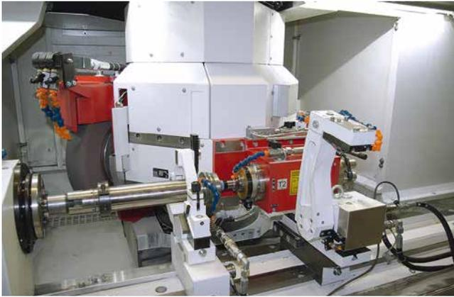
Mit einer Spitzenweite von 1.600 mm und dem mit zwei Außenschleifspindeln und zwei Innenschleifspindeln bestückten Revolverschleifkopf der neuesten S41 von Studer kann bei kptec components der größte Teil der täglich anfallenden Schleifarbeiten hochgenau und effizient ausgeführt werden.
